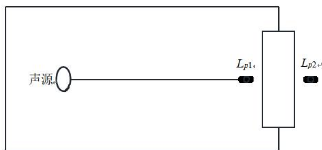
图 4-4 室内声源等效为室外声源图例
